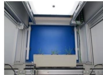
Dependendo da configuração pode ser incorporado ao sistema uma plataforma de levantamento e rotação da amostra permitindo a aquisição de imagens em ângulos que vão de 0 até 360°.
