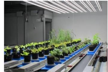
A configuração é otimizada para aplicações em ambiente semi-controlado e em casas de vegetação podendo ser personalizada em termos de rendimento e gama de sensores digitais integrados, de acordo com as necessidades experimentais. O **PlantScreen™ Modular System** é uma solução completa de fenotipagem utilizada para a movimentação de plantas e uma avaliação não invasiva abrangente e reprodutível de diversas características das plantas ao longo do tempo.
